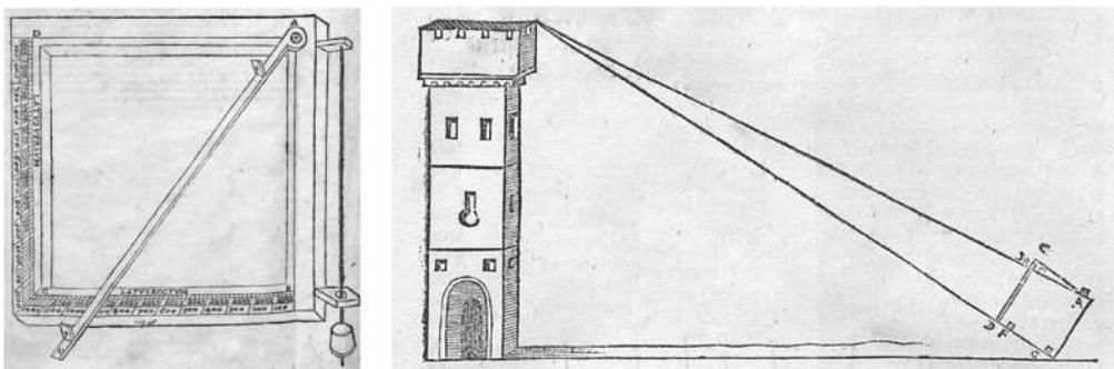
Рис. 21. Геометрический квадрат и измерение высоты с его помощью. На рисунке слева: геометрический квадрат. Georg von Peurbach (Georgij Burbachij). *Quadratum goetricum meridiano*. Nuremberg, 1516. Справа: Измерение расстояния до вершины башни. Petrum Apianum. *Instrument Buch*. Ingolstadt, 1533
