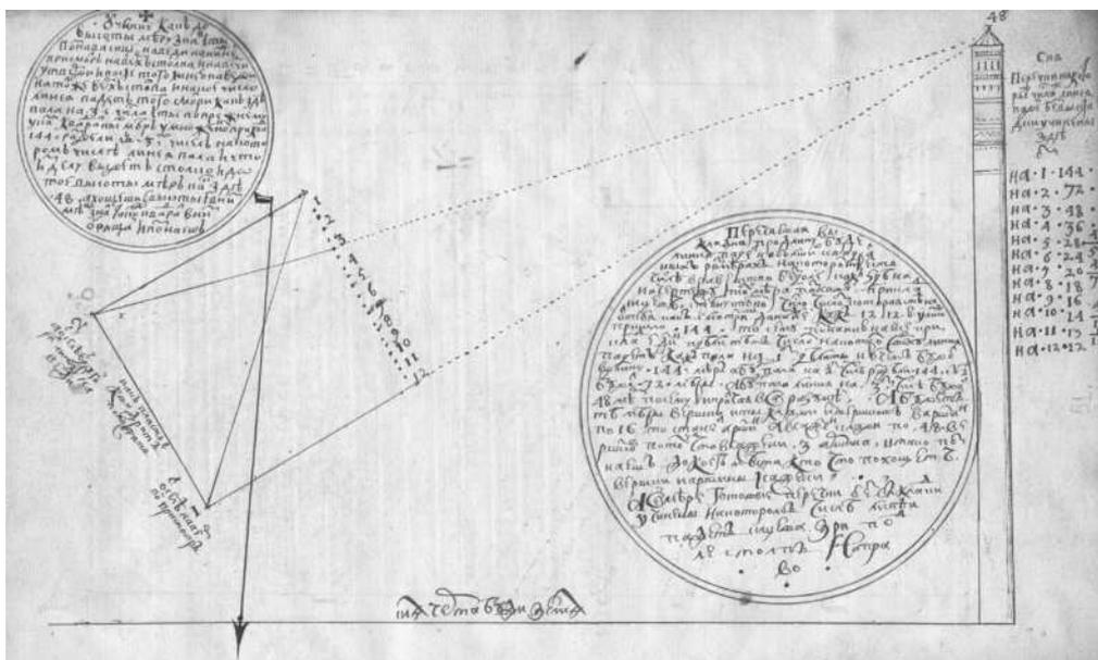
Рис. 20. Измерение расстояния до вершины башни при помощи геометрического квадрата. Страница из руководства. ОР РНБ. Ф. 550 (ОСРК). F. IX. № 47. Л. 51
