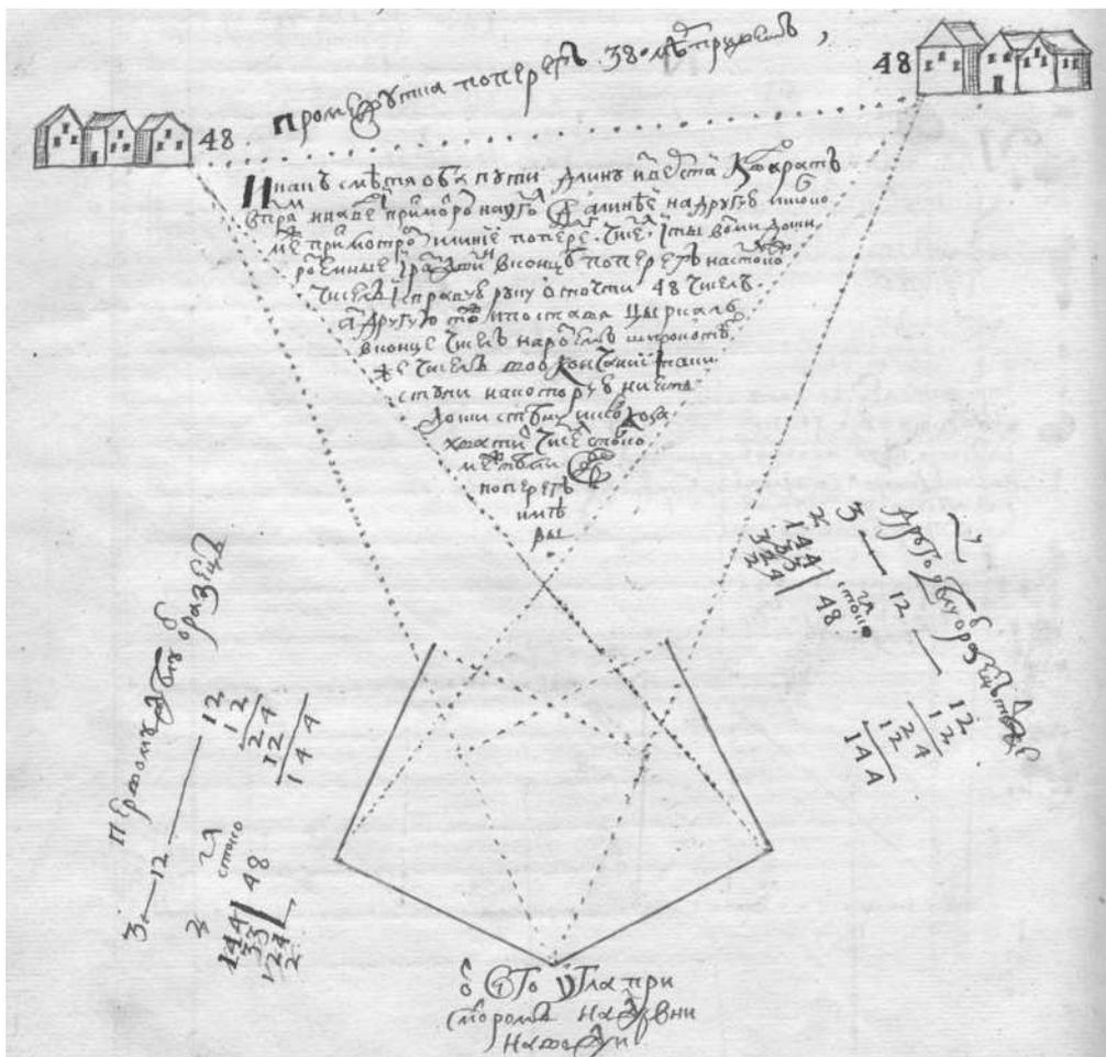
Рис. 22. Измерение расстояния между удаленными объектами при помощи геометрического квадрата. Рисунок из рукописи. ОР РНБ. Ф. 550 (ОСРК). F. IX. № 47. Л. 53 об.
