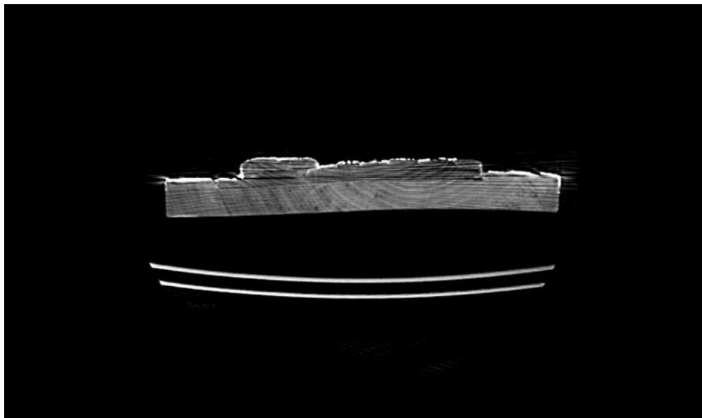
Рис. 11. Томографическая рентгенограмма основы иконы «Богоматерь Одигитрия» (поперечная)
